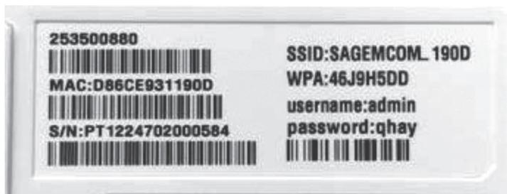
Avec le modem correspondant à l'exemple de fiche ci-haut, le nom de réseau sans fil (SSID) serait SAGEMCOM\_190D et la clé de chiffrement (WPA) pour se connecter à ce réseau sans fil serait 46J9H5DD.
